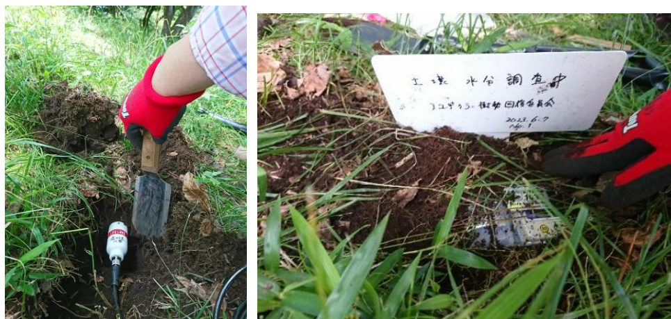
図 41 土壌水分センサー埋設の様子とロガー設置状況
