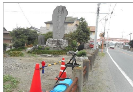
自動車騒音常時監視測定調査
