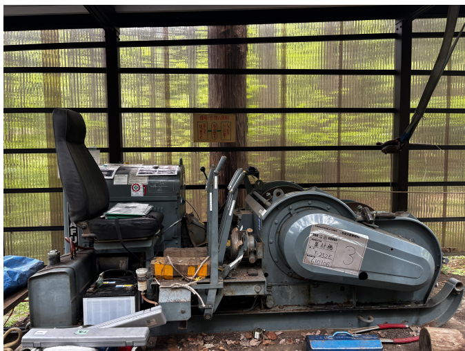
集材機（ワイヤーを巻き取る機械）
