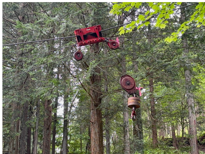
搬機（フックに木材を吊るして運搬）
