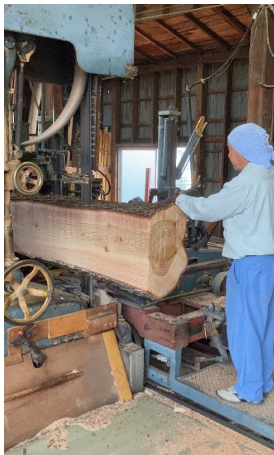
▶製材したヒマラヤスギと製材を引き受けてくださった和喜産業さん。木目がつまったきれいな板材が採れた。ヒマラヤスギはその名前に反してマツ科の樹木で、耐久性、耐腐敗性に優れる。
