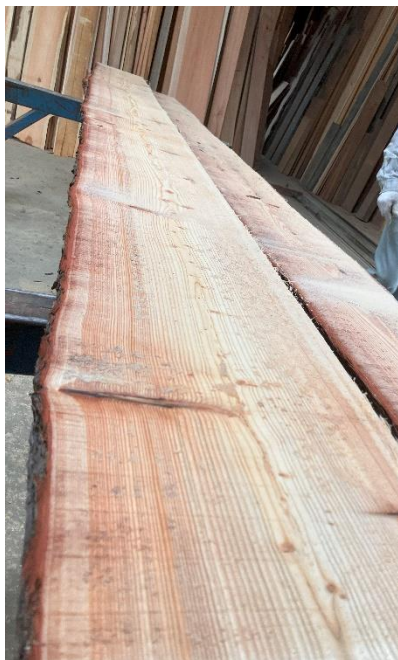
▶製材したヒマラヤスギと製材を引き受けてくださった和喜産業さん。木目がつまったきれいな板材が採れた。ヒマラヤスギはその名前に反してマツ科の樹木で、耐久性、耐腐敗性に優れる。
